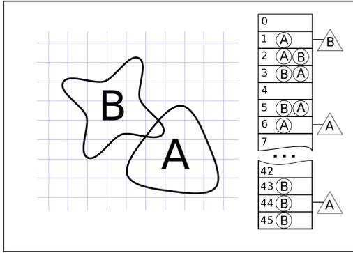
**Figure 1:** Ejemplo de dos objetos deformables colisionando, y la inserción de sus primitivas en celdas de la tabla hash.
