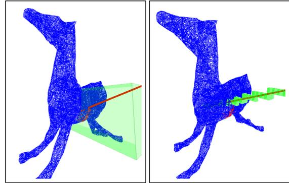
**Figure 5:** En la izqda., volumen de la caja contenedora del segmento de corte; y en la dcha., celdas de la partición espacial obtenidas con la técnica de voxelización propuesta.
