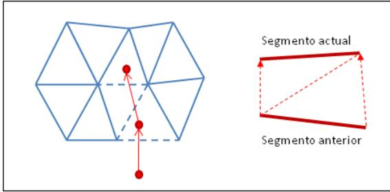
**Figure 4:** Durante el corte progresivo, la superficie recorrida por el segmento de corte en un periodo de muestreo se aproxima mediante dos triángulos, y se comprueba la intersección entre dichos triángulos y las aristas de la malla.
