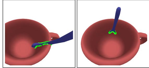
**Figure 9:** Cálculo de la intersección entre los modelos de una taza y una cuchara, en dos configuraciones distintas. La voxelización de primitivas aporta ganancias de eficiencia en este escenario de mallas irregulares.
